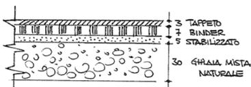
L'ipotesi progettuale prevede l'allargamento della fondazione stradale mediante lo scavo per la posa del seguente pacchetto stradale a tutela dell'integrità dello stesso nel tempo
