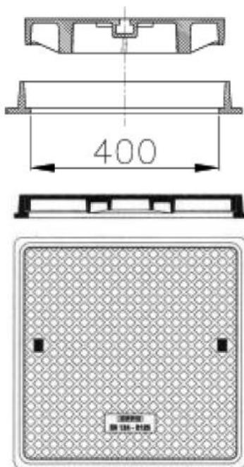
I pozzetti dovranno essere posizionati in corrispondenza di ciascuna derivazione e di ciascun cambio di direzione, ed almeno ogni 30 - 35 m nei tratti rettilinei.
