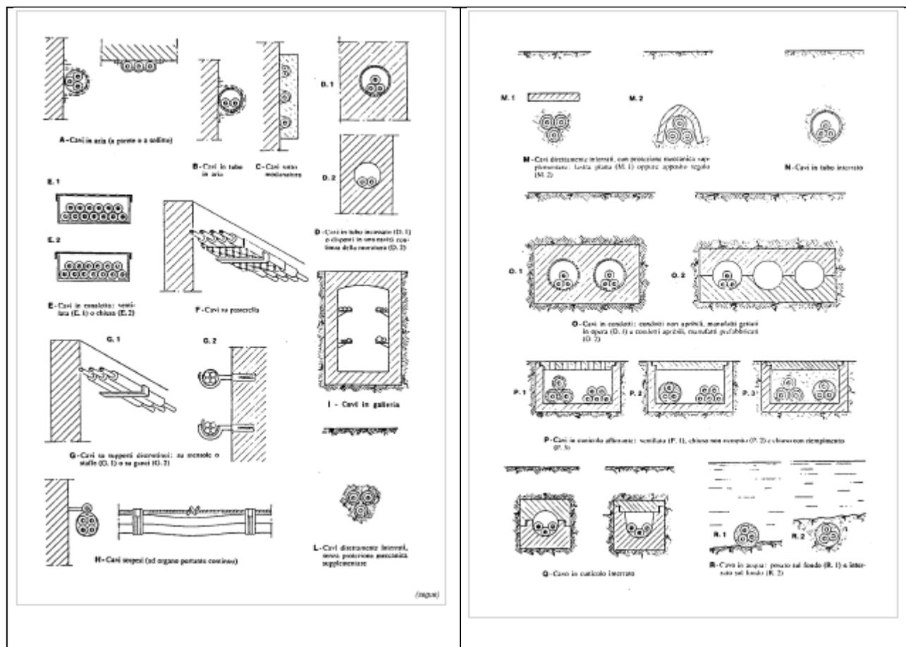
Si adatterà il tipo di posa "M" indicato dalla CEI 11-17; lo scavo dovrà essere minimo di 0,5 m sopra tubo per i tratti ordinari e 1 m per tutti gli attraversamenti stradali. All'interno dello scavo, posto al di sopra delle condutture, dovrà essere stesa una apposita segnalazione a nastro indicante la tipologia di impianto e la tensione di esercizio "condutture elettriche 400V".
