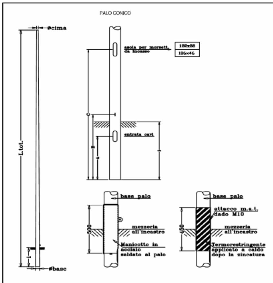
Per la protezione di tutte le parti in acciaio (pali, portello, guida d'attacco, braccio e codoli) è richiesta la zincatura a caldo secondo la norma CEI 7-6 (1968).
